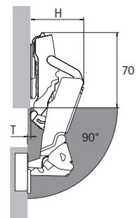
При дистанции D до 3 мм выступ двери T отсутствует, что обеспечивает эффективное использование внутреннего пространства, например для установки выдвижных элементов.
