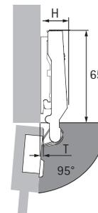
Высота петли H / выступ двери T для дистанции D = 0 мм и расстояния до чашки С = 3 мм
