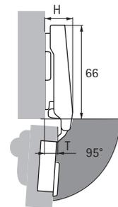
Высота петли Н / выступ двери Т для дистанции D = 0 мм и расстояния до чашки C = 3 мм
