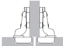
При навеске на среднюю стенку общую фугу между дверями необходимо выбрать так, чтобы она была равна по крайней мере двойному значению минимальной фуги. Иными словами, каждая дверь имеет меньшее наложение. Используются петли с большим изгибом.
