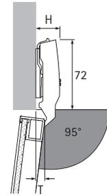
Высота петли H / выступ двери T для дистанции D = 0 мм и ширины профиля = 20 мм
