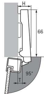
Высота петли H / выступ двери T для дистанции D = 0 мм и расстояния до чашки C = 3 мм
