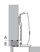
Наложение – это проекция двери на боковину. База – это проекция чашки на боковину корпуса при дистанции монтажной планки 0 мм.
