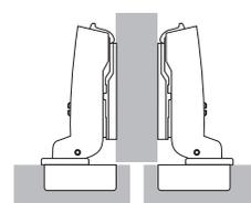
При навеске на среднюю стенку общую фугу между дверями необходимо выбрать так, чтобы она была равна по крайней мере двойному значению минимальной фуги. Иными словами, каждая дверь имеет меньшее наложение, поэтому используются петли с изгибом.
