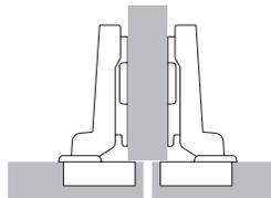
При навеске на среднюю стенку общую fuga между дверями необходимо выбрать так, чтобы она была равна по крайней мере двойному значению минимальной fuga. Иными словами, каждая дверь имеет меньшее наложение, поэтому используются петли с изгибом.
