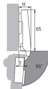
Высота петли H / выступ двери T для дистанции D = 0 мм и расстояния до чашки C = 3 мм
