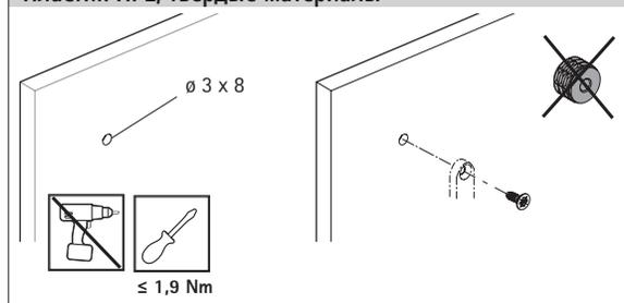
Метод монтажа должен выбираться в соответствии с типом и качеством материала фасада, крепление фасада должно быть проверено на прочность.
