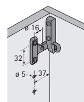
Скрытая задняя панель, монтаж с помощью MultiClip
