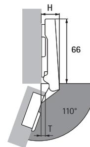
Высота петли Н / выступ двери Т для дистанции D = 0 мм и расстояния до чашки C = 3 мм
