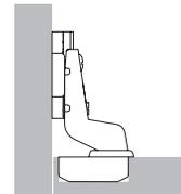
Дверь располагается внутри шкафа, т.е. она расположена заподлицо с боковинами, верхней и нижней панелями шкафа. В этом случае также необходима фуга для свободного открывания двери. Используются петли с большим изгибом. В случае вкладной навески отверстия для монтажных планок необходимо сместить к задней панели шкафа на толщину двери +1 мм и на требуемый выступ двери (по желанию).
