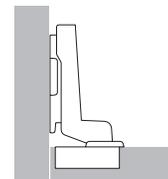
Дверь располагается внутри шкафа, т.е. она расположена заподлицо с боковинами, верхней и нижней панелями шкафа. В этом случае также необходима fuga для свободного открывания двери. Используются петли с большим изгибом. В случае вкладной навески отверстия для монтажных планок необходимо сместить к задней панели шкафа на толщину двери 1 мм и на требуемый выступ двери (по желанию).
