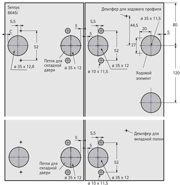
Примечание: расстояние до чашки С определяется наложением створки на боковину корпуса и высотой монтажной планки (см. раздел каталога "Петли")
