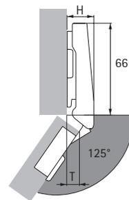
Высота петли Н / выступ двери Т для дистанции D = 0 мм и расстояния до чашки C = 3 мм
