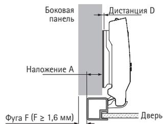
$$\text{Дистанция } D \text{ мм} = 4,5 \text{ мм} + B - A$$
