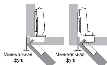
**При вкладной и накладной навеске** Минимальная фуга (также называемая минимальным зазором) – это расстояние сбоку двери, необходимое для ее свободного открывания. Размер минимальной фуги зависит от расстояния до чашки С, толщины двери и выбранного типа петли. Радиусы на краях дверей позволяют сократить необходимую минимальную фугу. Минимальная фуга указана в таблице соответствующего типа петли.
