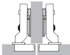
При навеске на среднюю стенку общую fuga между дверями необходимо выбрать так, чтобы она была равна по крайней мере двойному значению минимальной fuga. Иными словами, каждая дверь имеет меньшее наложение, поэтому используются петли с изгибом.
