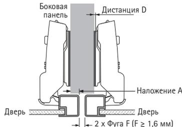
$$\text{Дистанция } D \text{ мм} = 4,5 \text{ мм} + B - A$$
