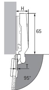
Высота петли H / выступ двери T для дистанции D = 0 мм и расстояния до чашки C = 5,5 мм
