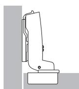
Дверь располагается внутри шкафа, т.е. она расположена заподлицо с боковиной, верхней и нижней панелями шкафа. В этом случае также необходима фуга для свободного открывания двери. Используются петли с большим изгибом. В случае вкладной навески отверстия для монтажных планок необходимо сместить к задней панели шкафа на толщину двери 1 мм и на требуемый выступ двери (по желанию).
