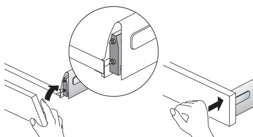
Шаблон для разметки установить в боковину выдвигаемого ящика
