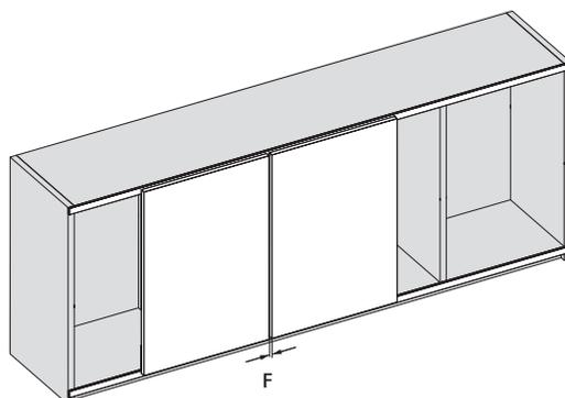
Зазор между дверями  $F$  зависит от положения отверстий  $B1$  и  $B2$  для монтажа ходовых и направляющих элементов. Стандартная карта сверления обеспечивает зазор  $F = 10$  мм.
